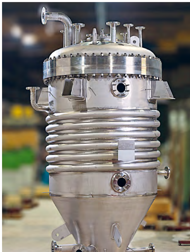
Filterkessel mit Heizschlange
