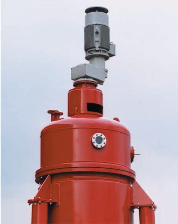
Als Standardausführung besteht die Antriebseinheit aus einem axial angeordneten Getriebe mit aufgebautem, frequenzgesteuertem Elektromotor. Über die Frequenzsteuerung kann die Rotationsgeschwindigkeit eingestellt werden.
